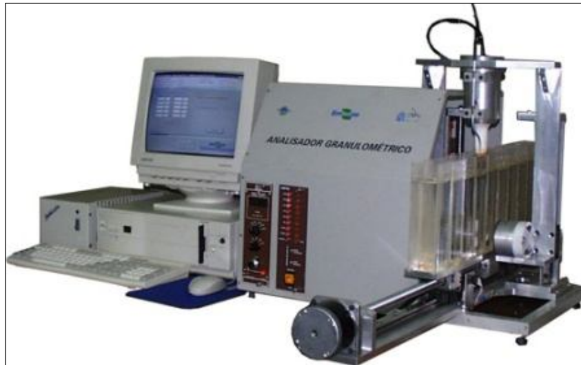
Figura 1 – Analisador granulométrico desenvolvido pela Embrapa Instrumentação Agropecuária, São Carlos-SP.
