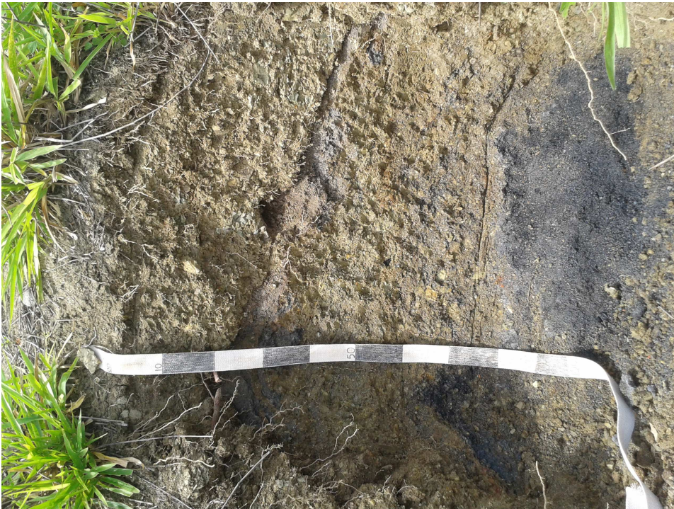
Figura 25 – Escórias de chumbo misturado com solos na área de estudo.
