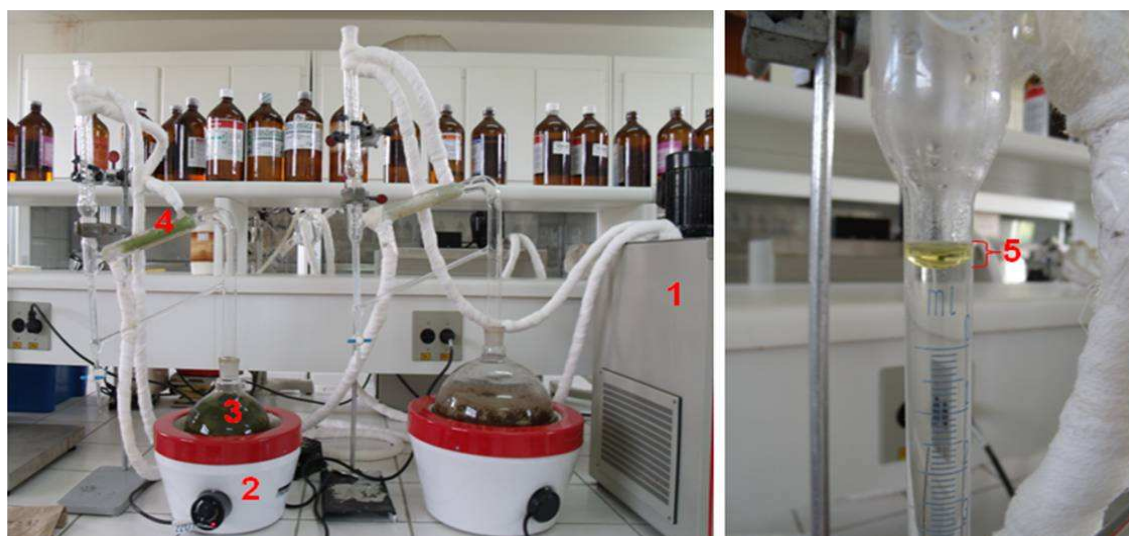
Figura 2. Aparelho de Clevenger utilizado para hidrodestilação do óleo essencial de acessos de Lippia alba (Mill) N. E. BR. cultivados no município de Cruz das Almas, BA. (1) Refrigerador do sistema; (2) Manta aquecedora; (3) Balão volumétrico; (4) Aparelho de Clevenger, e; (5) Volume de óleo extraído na coluna graduada do aparelho de Clevenger.
