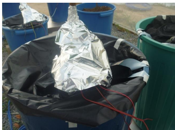
Figura 7. Isolamento térmico do caule com papel alumínio em formato de saia, acima e abaixo do sensor, permitindo a dissipação de calor do volume coberto, entre o caule e o laminado
