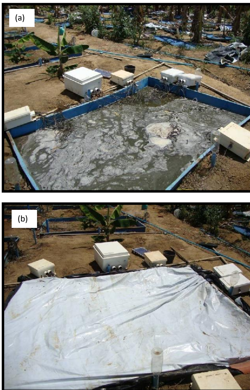
Figura 6. Ensaio de drenagem interna. Saturação (a) e cobertura com lona plástica para evitar evaporação (b).
