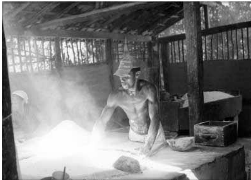
Figura 31 – Fotografia da torragem da massa de mandioca para fazer a farinha
