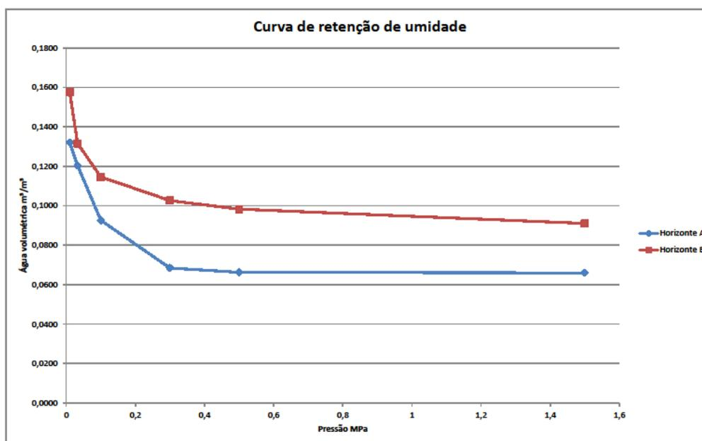
**Figura 4 – Curvas de retenção de umidade, nos horizontes A e B, de Argissolos em área de tabuleiro no Litoral Norte da Bahia**
