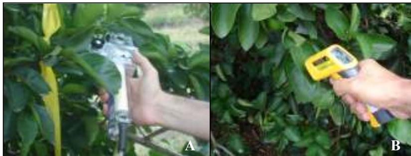
**Figura 2.** Medidas de Porometria (A); e termometria foliar por infravermelho (B).
