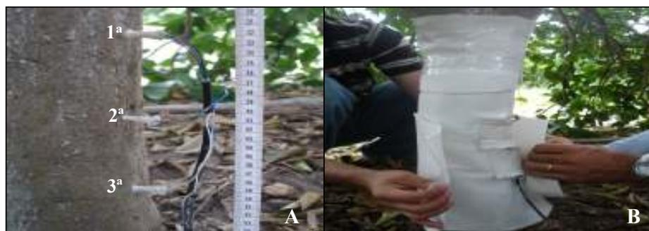
**Figura 4.** Detalhe da instalação dos sensores de *Granier* (A) e procedimento de isolamento em caule de Lima ácida 'Tahiti' (B).
