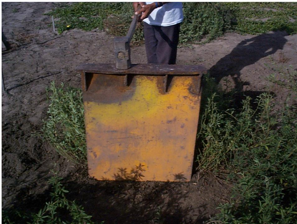
Figura 08 – Detalhe da introdução da guilhotina, antes da abertura da trincheira.
