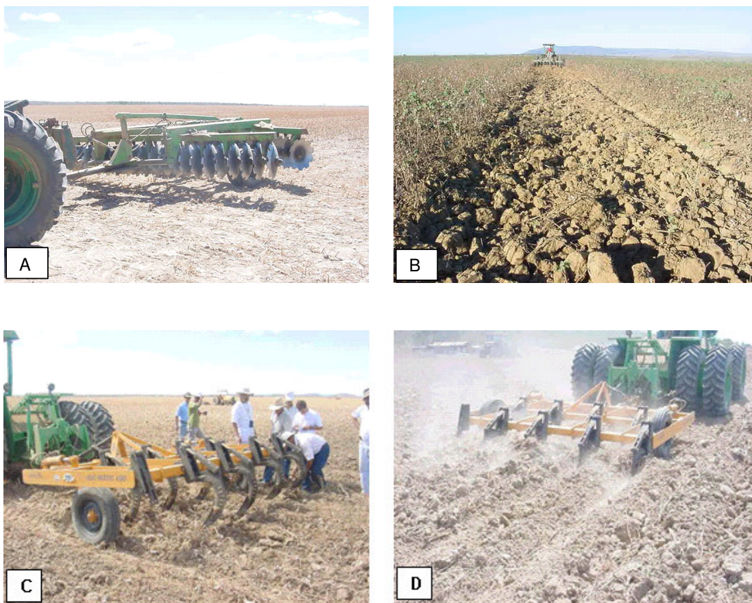
Figura 7 - Preparo do solo com grade pesada (A e B) e com escarificador (C e D). Palmas de Monte Alto, Bahia, 2004.
