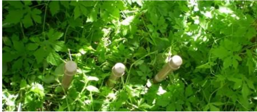
Figura 6. Tensiômetros utilizados para o monitoramento da tensão de água no solo, nas profundidades de 0,2; 0,4; e 0,6 m.
