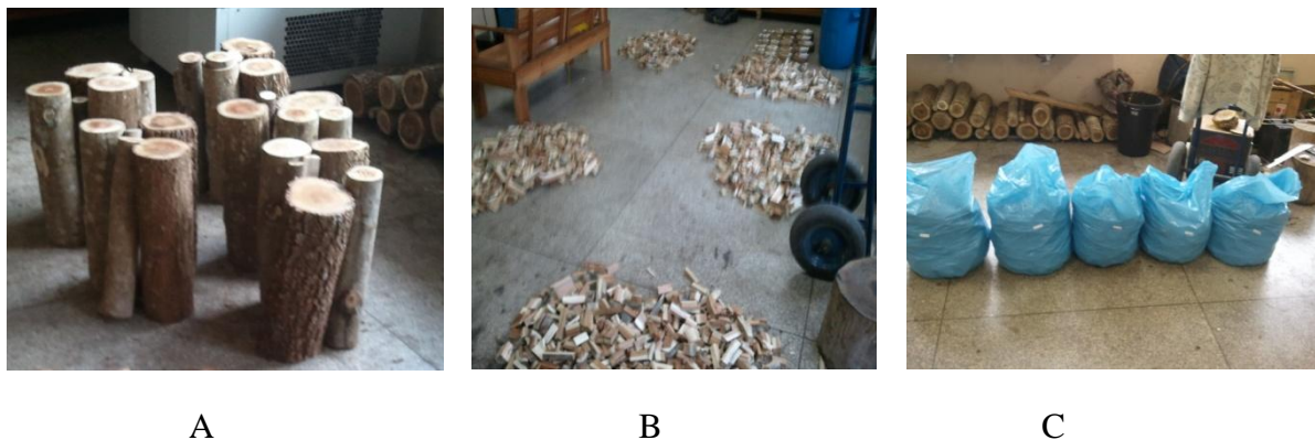
Figura 3: A – Madeiras em toras das cinco árvores separadas. B – Toras fragmentadas e separadas por árvores. C – Madeira fragmentadas e separadas acondicionadas em sacos plásticos.
