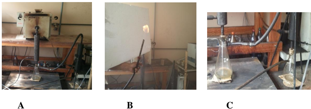
Figura 4: A – Adaptação do forno elétrico mufla modelo 1612 N1100, para carbonização e condensação de gases condensáveis. B – Queima de gases não condensáveis durante o processo de carbonização. C – Kitasatos para captura dos gases condensados.
