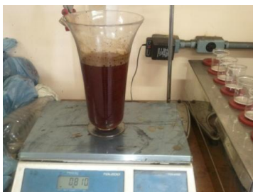
Figura 5: Procedimento de pesagem do licor pirolenhoso e alcatrão.
