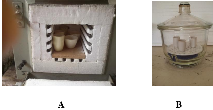
Figura 8: A - Compartimento do forno elétrico mufla modelo 0212 J 200, com os cadinhos contendo as amostras de carvão pesadas. B - Dessecadores com sílica gel em seu interior.
