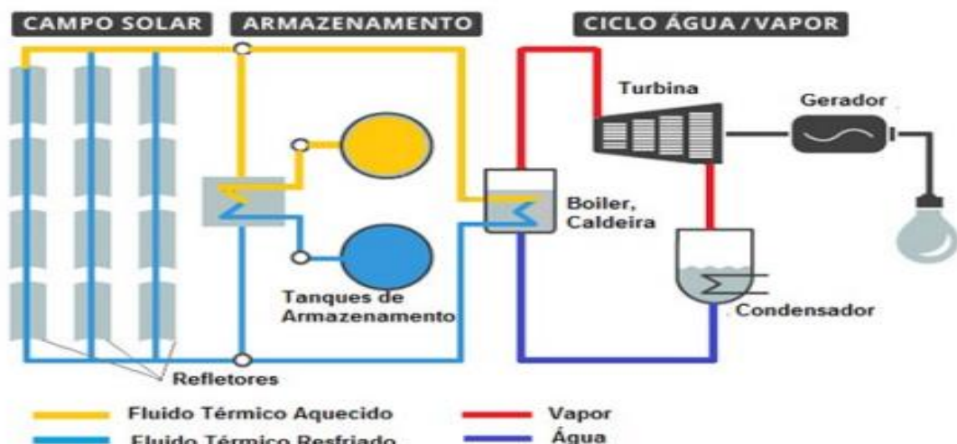
Figura 20 – Usina térmica solar com sistema de arrefecimento
