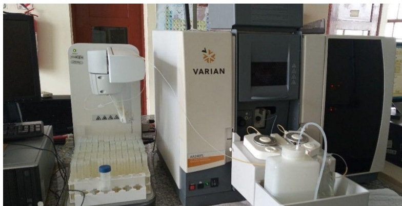
Figura 5. Determinação da concentração dos elementos por espectrometria de absorção atômica VARIAN (Modelo FS 240com SIPS)
