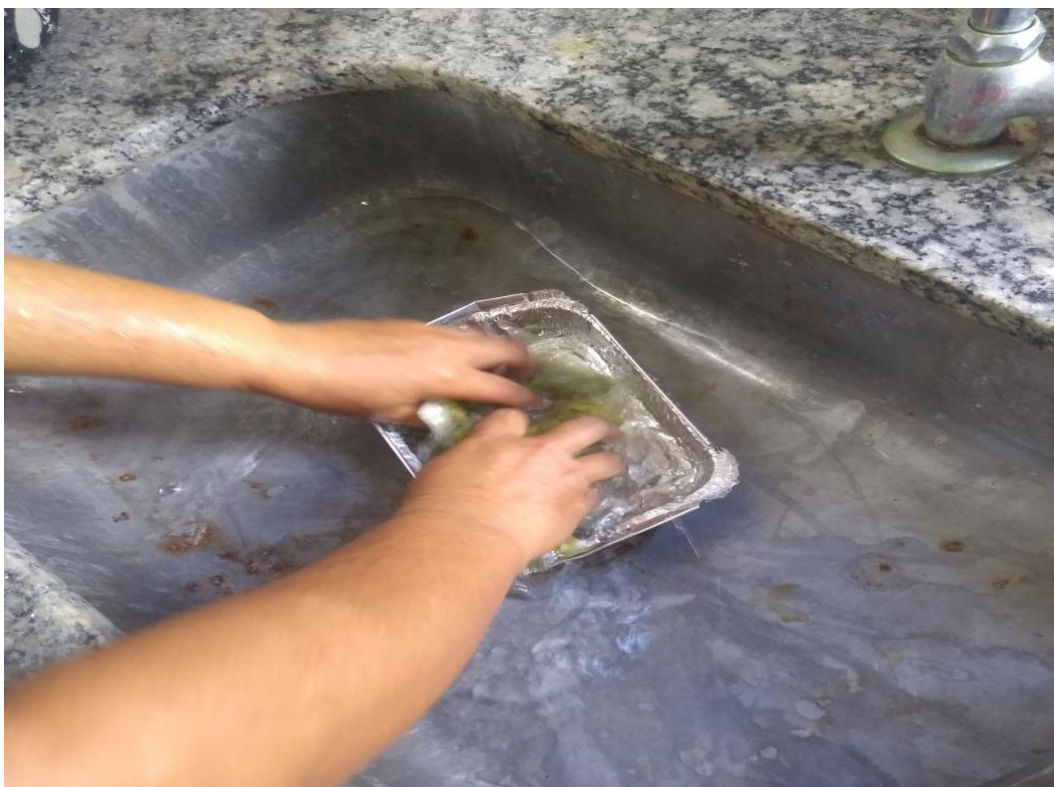
Figura 5 - Lavagem dos saquinhos de TNT com água destilada quente e acetona. Cruz das Almas, Bahia, Brasil. Fonte: acervo pessoal (2023).
