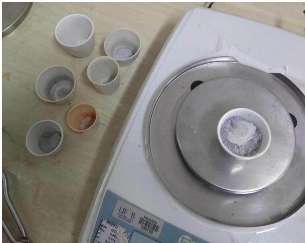
Figura 7 - Pesagem das cinzas de amostra de Clitoria ternatea . Cruz das Almas, Bahia, Brasil. Fonte: acervo pessoal (2023).
