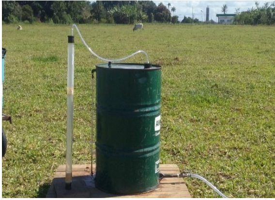
Figura 3. a) Vista do tanque reabastecedor de 200 L, juntamente com o frasco de Mariott de acrílico. b) Furo no solo com a mangueira reabastecedora e termômetro.
