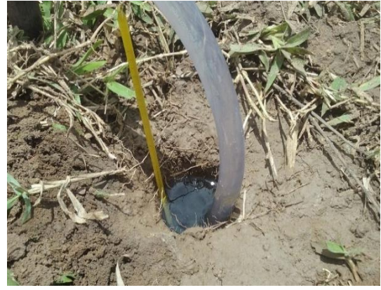
Figura 3. a) Vista do tanque reabastecedor de 200 L, juntamente com o frasco de Mariott de acrílico. b) Furo no solo com a mangueira reabastecedora e termômetro.
