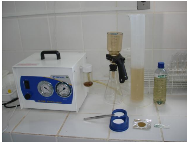
Figura 6: Filtragem das amostras em filtros Whatman GF/C e bomba a vácuo.
