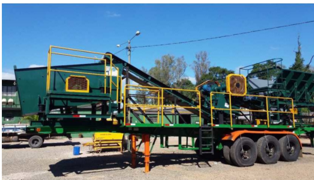
Figura 1 – Usina de RCC com Planta Móvel
