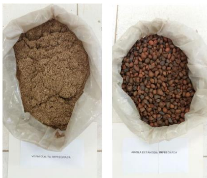
Figura 35: (a) Vermiculita super fina; (b) Argila expandida. (Fonte: EUZÉBIO; ALVES; FERNANDES, 2017)
