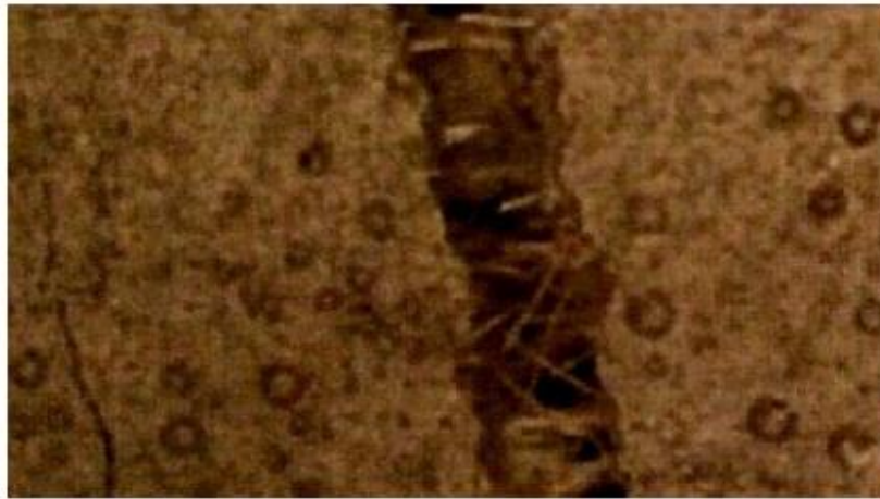
Figura 23: Autocicatrização com fibras de PVA
