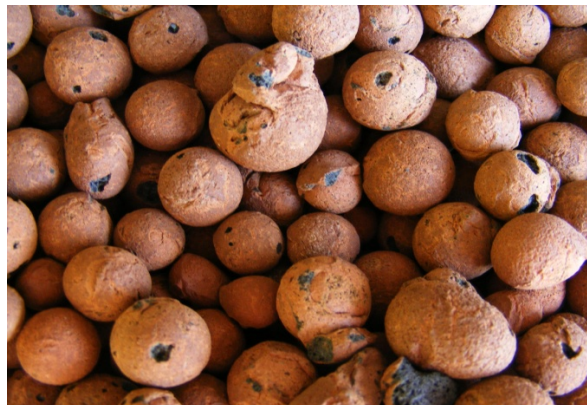
Figura 17. Argila expandida, utilizada tanto como mídia biológica, como cama de cultivo
