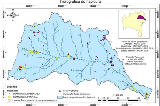
Figura 4.11 – Localização dos pontos de outorgas de usos de acordo com o INEMA para a bacia hidrográfica do Itapicuru
