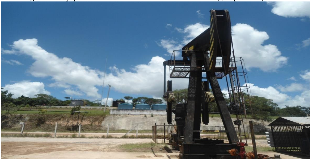
Figura 5.1- Equipamento utilizado na retirada do óleo – Cavalinho, (Próprio autor).
