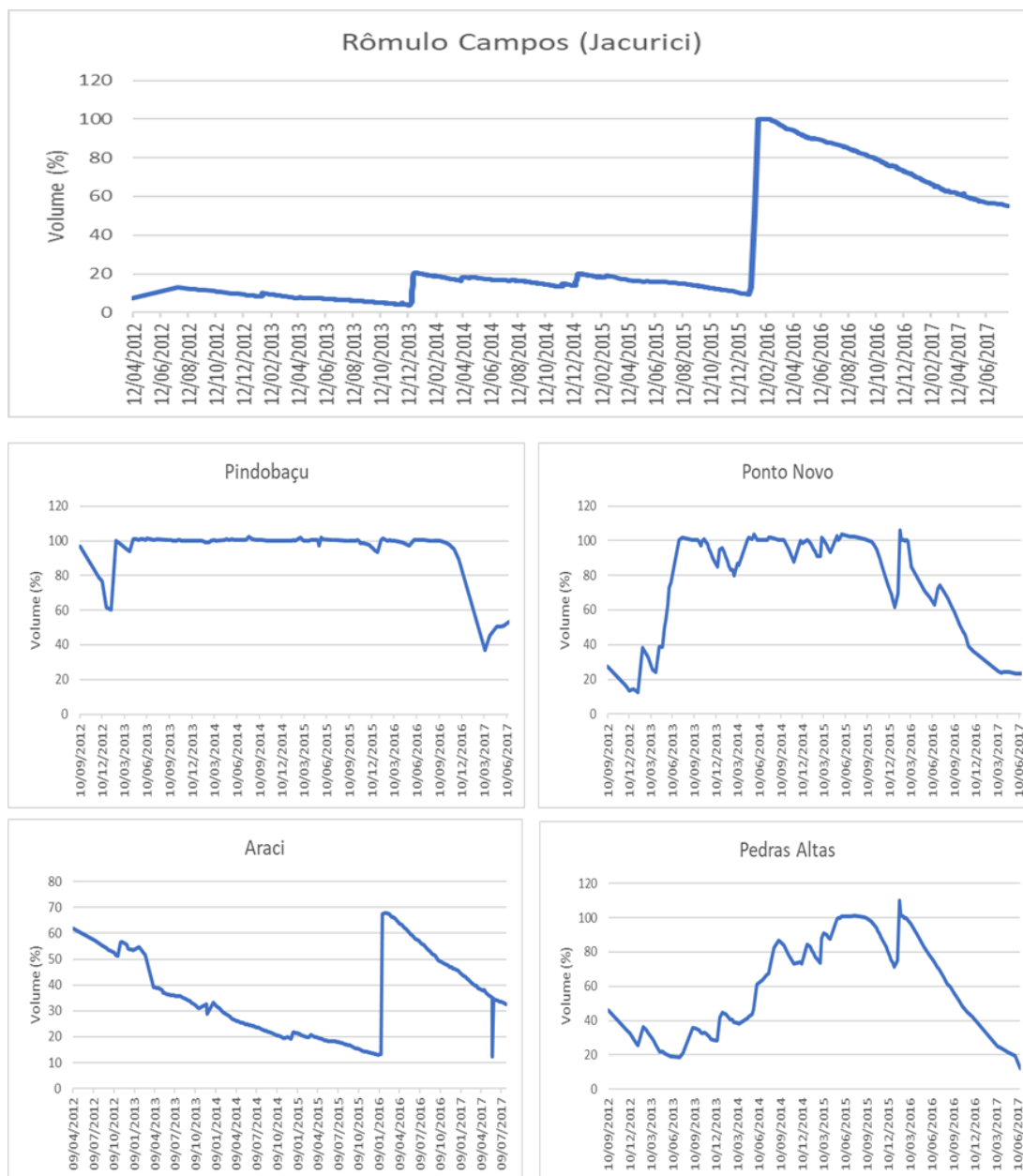
Figura 9 - Variação do Volume dos Principais Reservatórios da RPGA do rio Itapicuru
