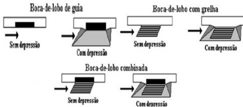
Figura 3-5– Principais tipos de bocas-de-lobo
