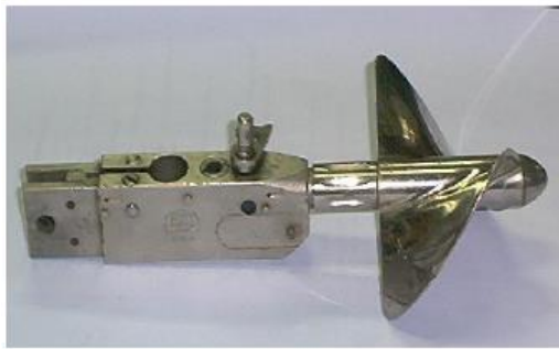
Figura 1 - Molinete com hélice e molinete com concha respectivamente
