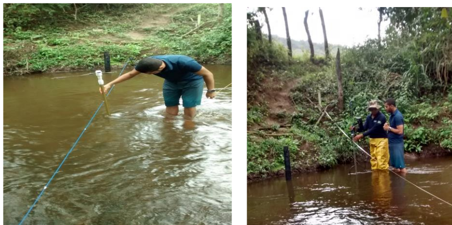
Figura 16 - Medição de Vazão pelo Método do Molinete
