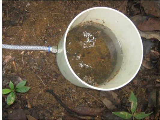
Figura 8. Disposição do módulo de infiltração no campo.
