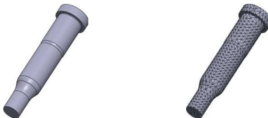
Figura 16 – Modelos de um punção: (a) em CAD e (b) em elementos finitos. Fonte: Petrova (2014)
