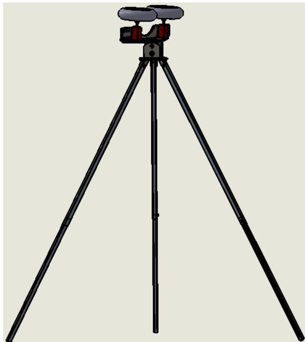
Figura 29: Montagem completa do lançador de bolas.
