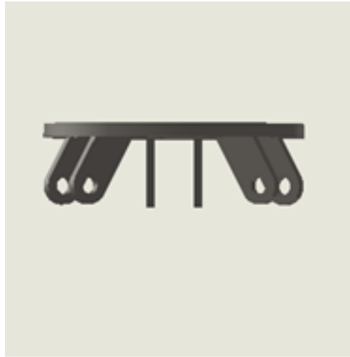
Figura 14: Montagem dos suportes das pernas no disco dos suportes.
