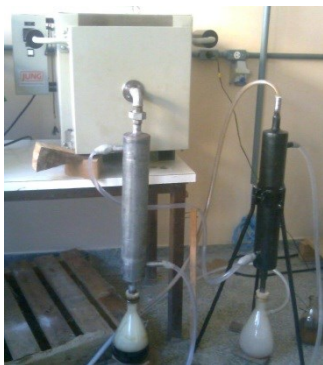
Figura 1. Forno mufla com adequações para carbonização e condensação de gases.
