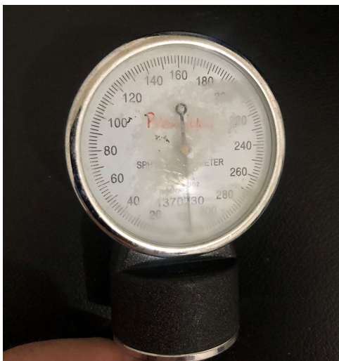
Figura 14. Manômetro de pressão com baixa de clareza na visualização da escala de pressão, Bahia, 2020.
