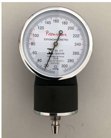
Figura 12. Agulha do manômetro de pressão, na marcação de 20 mmHg, fora do zero de referência, Santo Antônio de Jesus, 2020.
