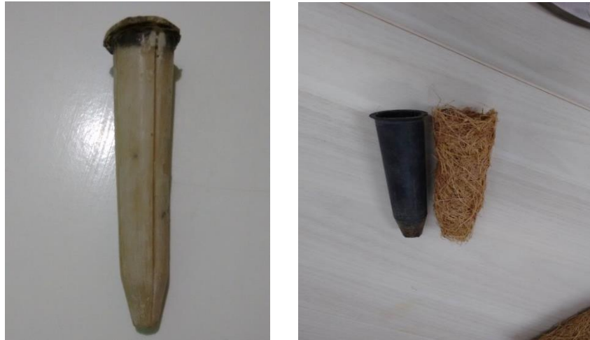
Figura 5. À esquerda, molde maciço de fibra de vidro. À direita, comparação de dimensões do tubete biodegradável com tubete de plástico.
