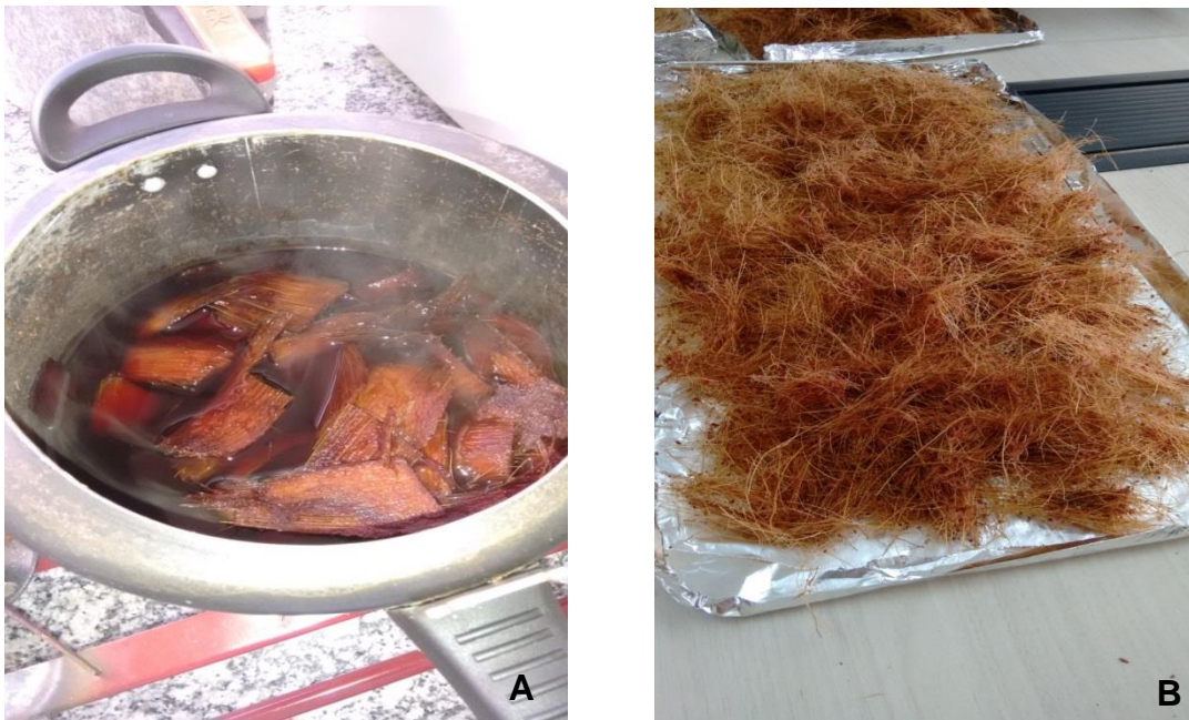
Figura 3. Cozimento dos cavacos (A) e as fibras deslignificadas (B).
