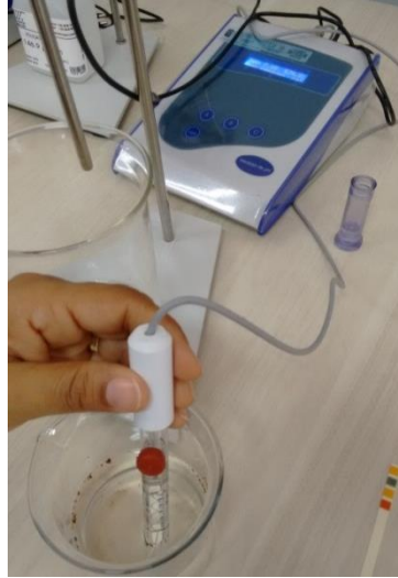
Figura 6. Análise das soluções com uso de peagâmetro.
