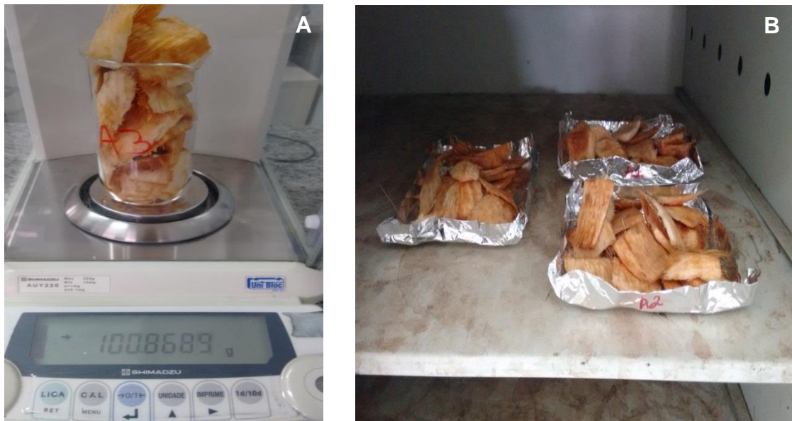
Figura 2. Pesagem das amostras (A) e secagem dos cavacos em estufa com circulação de ar forçada (B).
