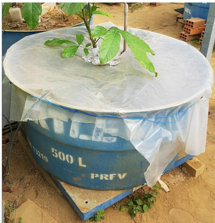
**Figura 4.** Reservatório com superfície coberta por lona plástica para calibração do método de Granier.
