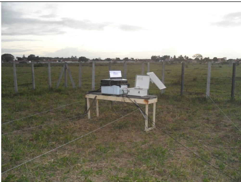
Ponto I (Sondas TDR e dados meteorológicos)
