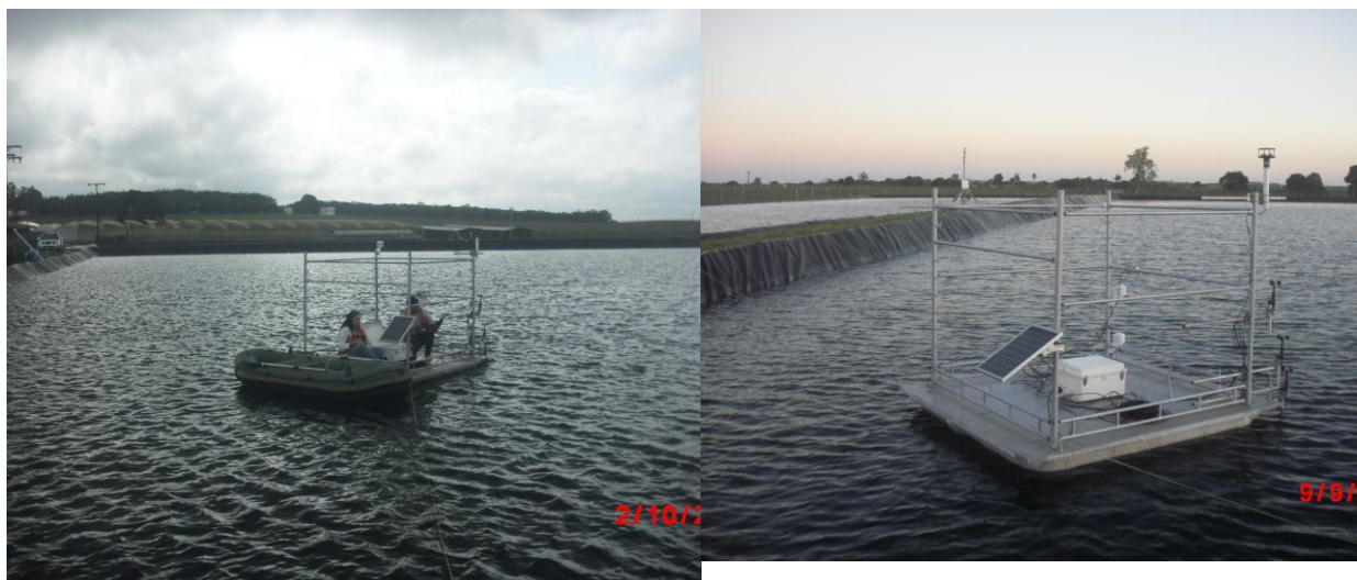
Figura 10 - Descarregamento dos dados e plataforma flutuante com todos os sensores instalados.
