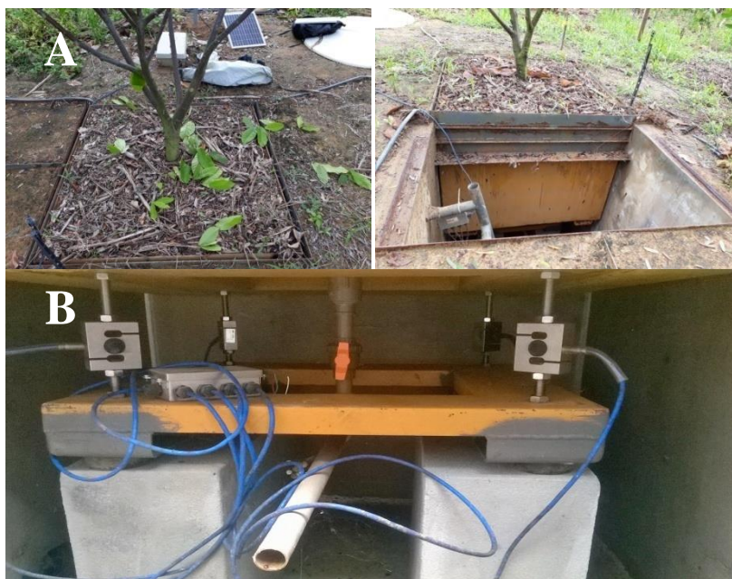
Figura 1. Cultivo de cacau clonal - CCN 51 em uma caixa lisimétrica (A) instalada sobre quatro células de carga (B).
