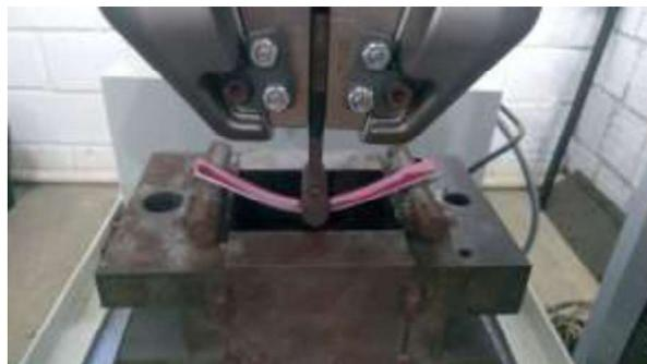
Figura 15- Ensaio de Flexão
