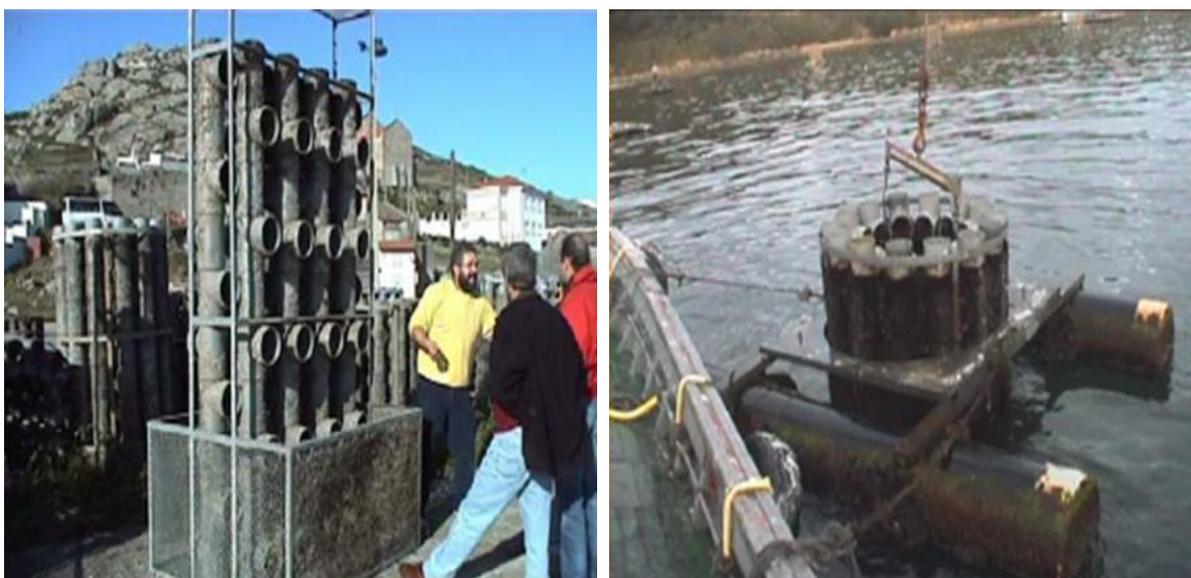
Figuras 12 e 13 – Jaulas flutuantes retangular e cilíndrica, onde vê-se os abrigos e “tocas”.
