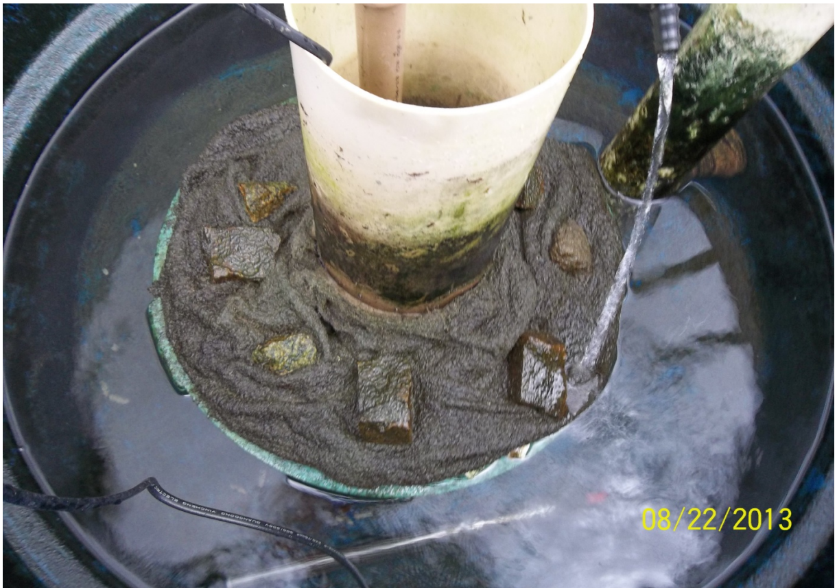
Figura 11. Filtro biológico montado (30 dias de funcionamento)
