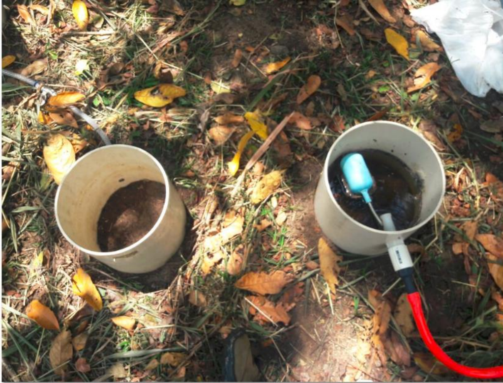
Figura 1. Módulos de infiltração dos infiltrômetros cilíndricos utilizados no teste de infiltração: infiltrômetro de Mariotte sem boia, à esquerda, e infiltrômetro simples, com boia, à direita. Fonte: Souza (2018).
