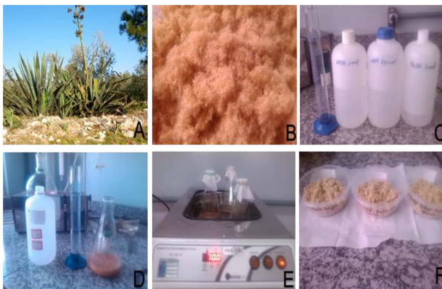
Figura 06. Pré-tratamento alcalino do sisal. A. Agave sisalana Perrine; B. Fibras; C. Solução de NaOH; D. ;E. Banho ultratermostático; F. Fibras após tratamentos.
