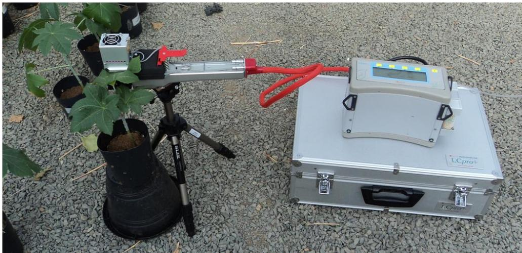
**Figura 2.** Sistema de medição de trocas gasosas, portátil LC-pro+ (ADC Bioscientific Ltd., England) equipado com uma fonte de luz azul/vermelho.
