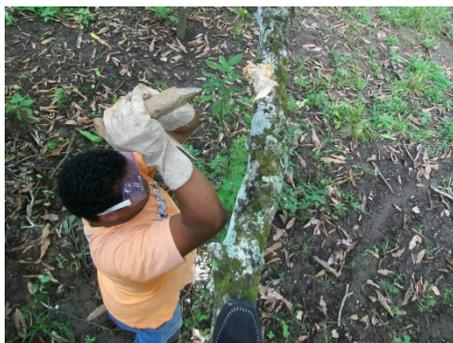
**FIGURA 8** - Uso da lâmina Nº 1 no corte da madeira
