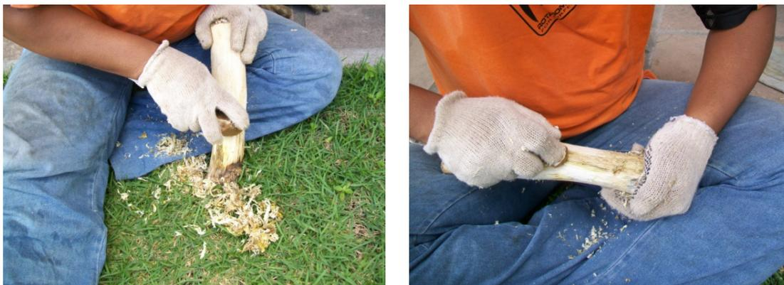
**FIGURA 7** – Instrumentos N° 13 e N° 20 (respectivamente), uso na raspagem dos cabos.
