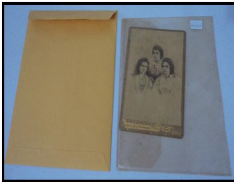
Figura 44- Acondicionamento inadequado da fotografia em envelope pardo, provocando acidez no suporte da fotografia. Fonte: Autora, 2011.
