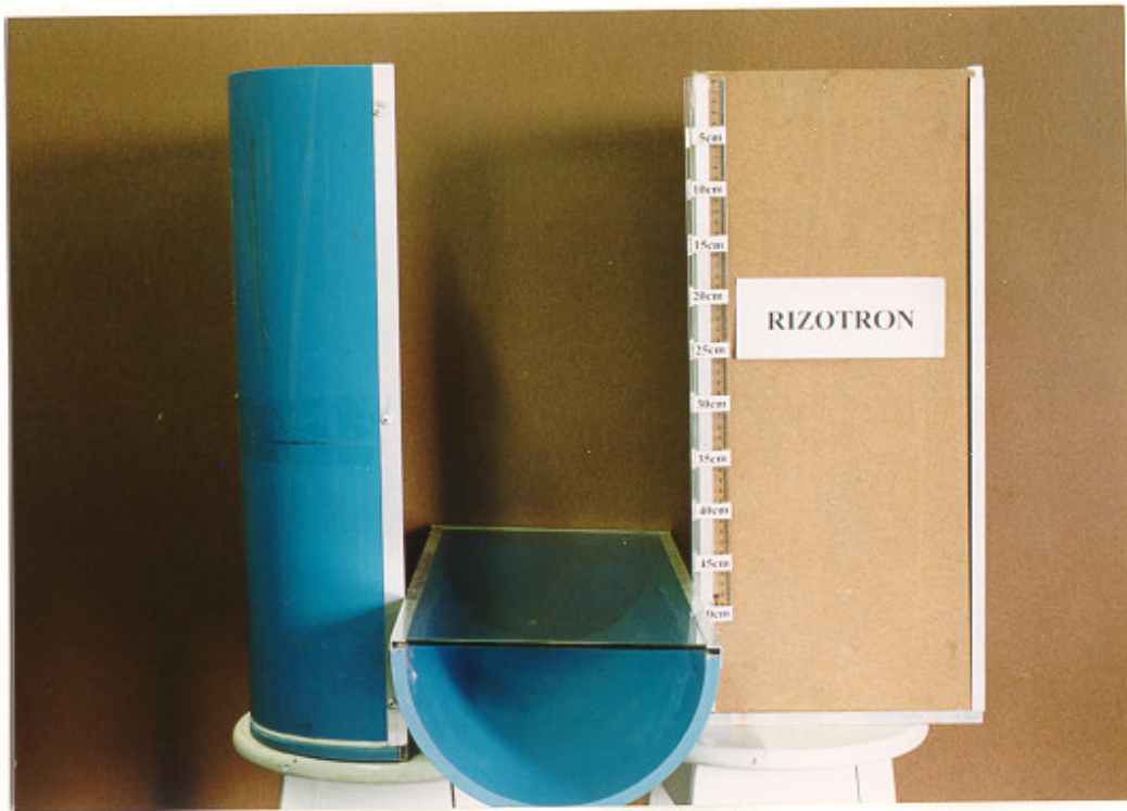
Figura 1. Rizotrons construídos a partir de tubos de PVC em formato semi-circular utilizados no experimento.
